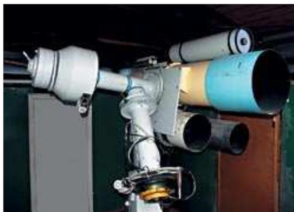
У робота-телескопа МАСТЕР четыре трубы: основная (35 см) регистрирует звезды до 19—20<sup>m</sup>, остальные параллельно ведут съемку с различными фильтрами, но могут уловить только яркие объекты
